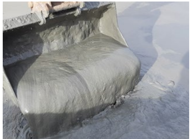
De bagger bij binnenkomst, licht verontreinigd en veel water
